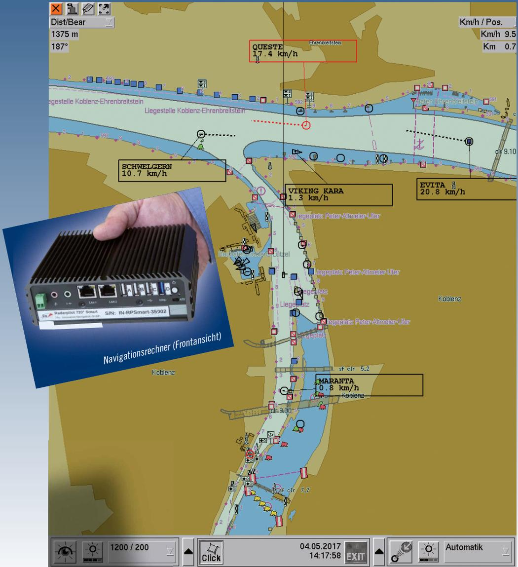
**RADARpilot720°smart** ist speziell für den Einsatz als ECDIS- und AIS-Anzeige konzipiert und besteht aus einem sehr kompakten, robusten und hochmodernen Rechner, der auf jedem Schiff noch seinen Platz findet.
